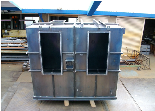
活性炭吸着塔
